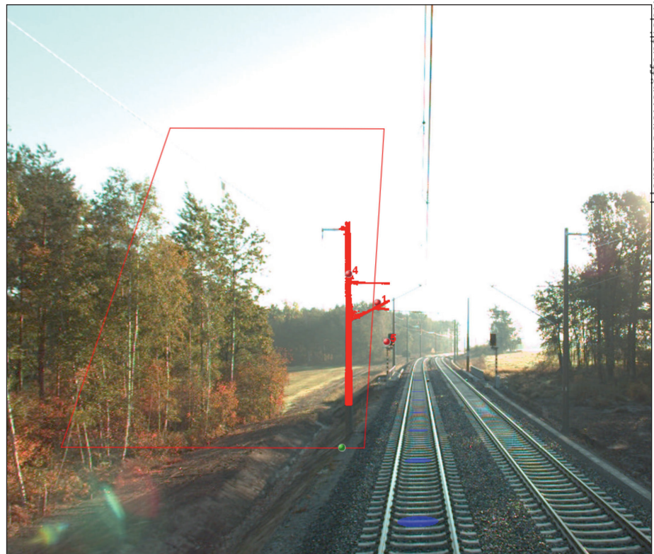
Abb. 4: Beispiel einer Kollisionsprüfung, im Kollisionsbereich wird jeder Laserpunkt rot markiert.
